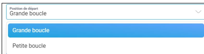
2 parcours sont proposés. Ce paramètre permet de positionner le véhicule sur l'un des deux circuits pour démarrer la séance. Le type de boucle est choisi à partir de la liste déroulante.
